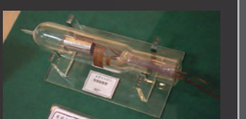
岡部博士が 1927 年、最初の実験に使用した 2 分割陽極マグネトロン (資料展示室)
