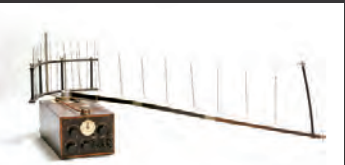
八木・宇田アンテナを使用した波長 45cm の UHF 帯の送受信機。この装置を用いて 1929 年に仙台と大鷹森の間、約 20km の通信に成功した。(資料展示室)
